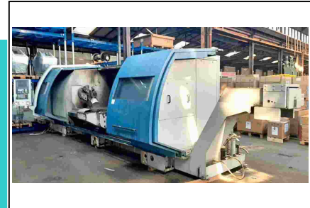
Drehmaschine - zyklengesteuert KERN-DMT CD 1000 / 3000 Nr. 1032-03923 Baujahr 2010 Drehdurchmesser 1000 / 700 mm Drehlänge 3000 mm Steuerung
