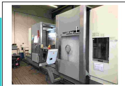
Bearbeitungszentrum - Universal DECKEL MAHO DMG DMF 250 linear Nr. 1032-03915 Baujahr 2007 x-Weg 2500 mm y-Weg 920 mm z-Weg 820 mm
