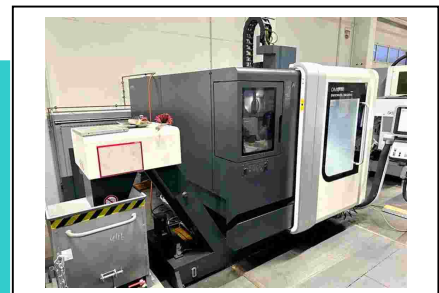
Bearbeitungszentrum - Universal DECKEL DMU 50 (simultan) Nr. 1032-03916 Baujahr 2012 x-Weg 500 mm y-Weg 450 mm z-Weg 400 mm
