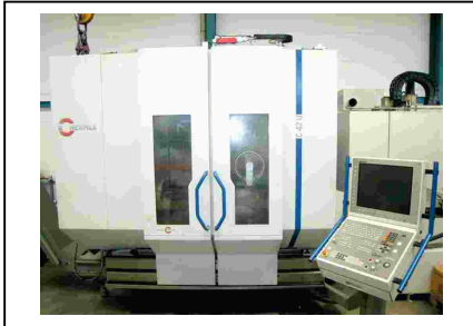
Bearbeitungszentrum - Universal HERMLE C 42 U Nr. 1032-03917 Baujahr 2013 x-Weg 800 mm y-Weg 800 mm z-Weg 550 mm
