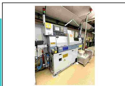
Langdrehautomat STAR MICRONICS SR 10J type C Nr. 1032-03928 Baujahr 2008 Stangendurchmesser 10 mm Drehlänge 105 mm Drehzahl 15.000 / 10.000 U/min
