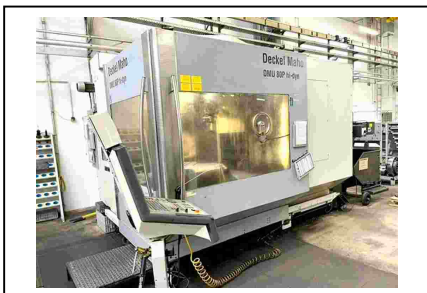
Bearbeitungszentrum - Universal DECKEL DMU 80 P HiDyn Nr. 1032-03914 Baujahr 2002 x-Weg 800 mm y-Weg 700 mm z-Weg 600 mm
