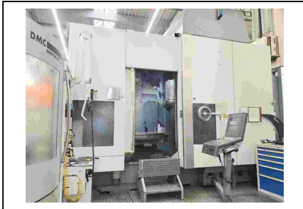
Bearbeitungszentrum - Universal DECKEL MAHO DMC 200 FD Nr. 1032-03921 Baujahr 2006 x-Weg 1800 mm y-Weg 2000 mm z-Weg 1100 mm
