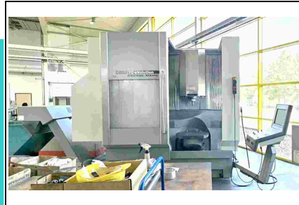
Bearbeitungszentrum - Universal DECKEL DMU 70 eVolution Nr. 1032-03893 Baujahr 2003 x-Weg 750 mm y-Weg 600 mm z-Weg 520 mm
