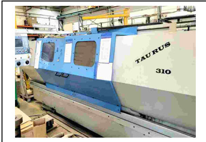
Drehmaschine - zyklengesteuert PINACHO TAURUS 310 CNC Nr. 1032-03863 Baujahr 2002 Drehdurchmesser 620 mm Drehlänge 2.000 mm Revolverkopf (x-fach) 8
