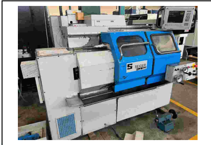
Drehmaschine - zyklengesteuert SEIGER SLZ 360-750 Nr. 1032-03622 Baujahr 1999 Drehdurchmesser 380 mm Drehlänge 750 mm Steuerung Manual Plus Heidenhain
