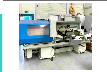
Drehmaschine - zyklengesteuert VDF BOEHRINGER DUS 400 ti Nr. 1032-03831 Baujahr 2006 Drehdurchmesser 420 mm Drehlänge 1130 mm Steuerung Heidenhain manual plus 411
