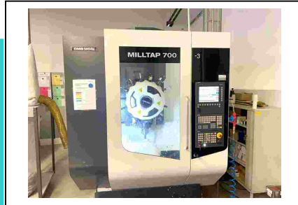
Bearbeitungszentrum - Universal DMG-DECKEL MILLTAP 700 Nr. 1032-03918 Baujahr 2014 x-Weg 700 mm y-Weg 420 mm z-Weg 380 mm
