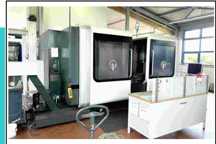
Bearbeitungszentrum - Universal DECKEL DMF 260 / 7 Nr. 1032-03908 Baujahr 2009 x-Weg 2600 mm y-Weg 700 mm z-Weg 700 mm
