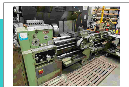
Leit- und Zugspindeldrehmaschine LACFER CR2E - 250 Nr. 1032-03905 Baujahr 1986 Drehdurchmesser über Bett 530 mm Drehdurchmesser über Support 320 mm Drehlänge 2000 mm
