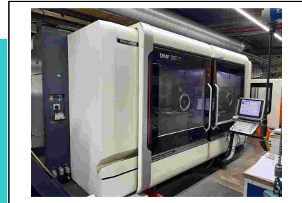
Bearbeitungszentrum - Universal DECKEL DMF 260 / 7 Nr. 1032-03929 Baujahr 2018 x-Weg 2600 mm y-Weg 700 mm z-Weg 700 mm
