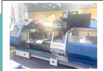
Drehmaschine - zyklengesteuert KERN-DMT CD 650 / 2000 Nr. 1032-03913 Baujahr 2002 Drehdurchmesser 650 mm Drehlänge 2000 mm Steuerung
