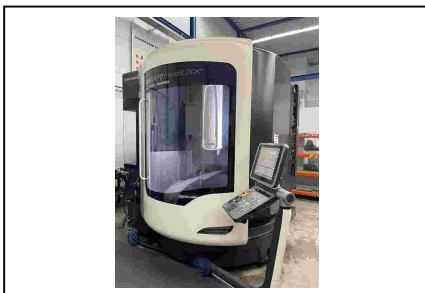
Bearbeitungszentrum - Universal DECKEL MAHO DMU 65 FD Nr. 1032-03932 Baujahr 2013 x-Weg 735 mm y-Weg 650 mm z-Weg 560 mm
